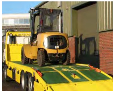
Cubierta para vehículos plataforma
