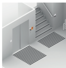
En los arranques y desembarques se colocarán de forma transversal al eje del elemento a señalar y cubriendo la anchura total del elemento (± 10cm).
